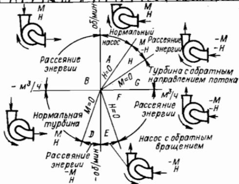
отрицательная частота вращения (турбинный режим); л. с. — мощность прикладывается к валу; — л. с. — мощность отбирается от вала;  $M$  — мощность и частота вращения положительные или обе величины отрицательные; —  $M$  — мощность отрицательная и частота вращения отрицательная или мощность положительная, а частота вращения отрицательная
