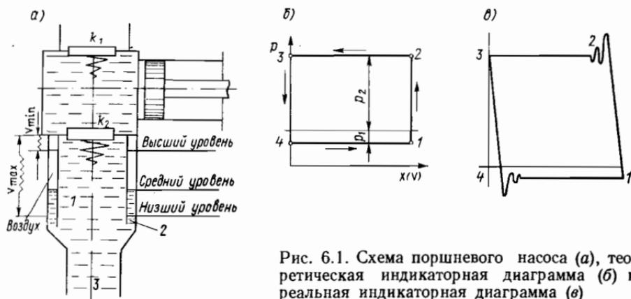
Рис. 6.1. Схема поршневого насоса (а), теоретическая индикаторная диаграмма (б) и реальная индикаторная диаграмма (в)
